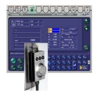
Le mode « manuel » (programmation par profondeur de pliage) permet à l'utilisateur de saisir les cotes de positionnement des axes ou procède par apprentissage à l'aide du volant de programmation. Le volant gradué en centièmes de millimètres assure la variation très progressive de la pénétration poinçon/matrice. Une touche de validation permet de mémoriser le réglage des axes. Ce mode permet d'utiliser, aussi, des outils spéciaux.
