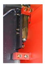
Le tablier supérieur est guidé par un ensemble de quatre paires de roulements largement dimensionnés, prenant appui sur des pistes en acier traités et rectifiés, solidaires des flasques de la machine. L'écartement maximum des roulements supérieurs et inférieurs assurent un centrage et un alignement rigoureux des tabliers avec une parfaite rigidité.
