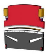
Déformées parallèles des tabliers (Brevet AMADA) Une pénétration constante sur la longueur de la presse du poinçon dans la matrice garantit une régularité du pli. Le concept unique du tablier inférieur dit « Réactif » permet une largeur étroite de celui-ci (60mm).
