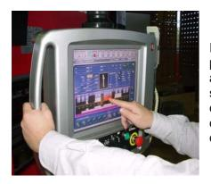
Il ne lui reste plus qu'à mettre en place l'outillage requis dans la position indiquée à l'écran. Il est également possible d'accéder au programme par simple appel sur le disque dur de la CNC ou sur le réseau de l'entreprise selon les configurations. Le dispositif de pilotage permet de procéder à une programmation directe de la pièce sur la machine, selon 4 modes différents dont un mode 2D et demi très convivial.
